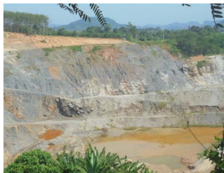
รูปที่ 2-17: การทำเหมืองแบบขั้นบันได
