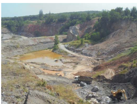
รูปที่ 2-14: บ่อรับน้ำบริเวณพื้นที่ที่มีระดับต่ำสุด ของหน้าเหมือง (Sump)
